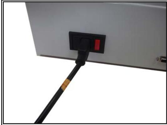
Connectez le câble secteur à l'embase secteur situé sur la face arrière de votre couplemètre, et effectuez une charge des batteries pendant 4-6 heures .Utilisez uniquement l'adaptateur fourni par ANDILOG, dans la mallette.
